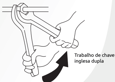
Fig. 4.2. Trabalho do Aperto da Porca de Alargamento
