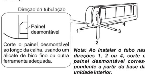
Depois de conectar a tubulação conforme necessário, instale a mangueira de drenagem. Em seguida, conecte os cabos de alimentação. Após a conexão, enrole a tubulação, cabos e a mangueira de drenagem juntamente com materiais de isolamento térmico.
