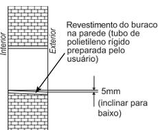
Instale um revestimento através do furo na parede para manter a parede arrumada e limpa.
